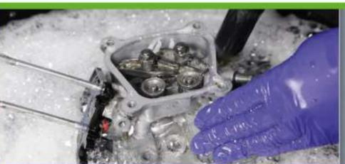
Durch Erhitzung auf 42 °C werden die Mikroben in der ROWash-Lösung aktiv und fressen Öl und Fett, wandeln es in CO<sup>2</sup> und Wasser um und recyceln die Flüssigkeit effektiv.
