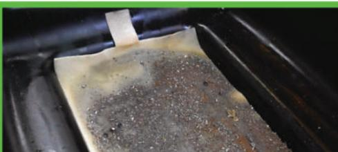
Il filtro è l'ELEMENTO ESSENZIALE del sistema - oltre a intrappolare particelle di dimensioni fino 50 micron, contiene anche milioni di microrganismi Rozone.
