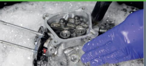
Chauffés à 42 °C, les micro-organismes deviennent actifs dans la solution ROWash, dévorent l'huile et la graisse et les transforment en CO<sup>2</sup> et en eau, permettant ainsi de recycler efficacement le fluide.
