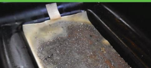
Le filtre est la CLÉ du système - non seulement il retient les particules jusqu'à 50 microns, mais il contient également des millions de micro-organismes Rozone.
